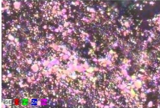
**Gambar 4.10** Penyebaran Komposisi Penyusun BaM Menggunakan SEM-EDX
