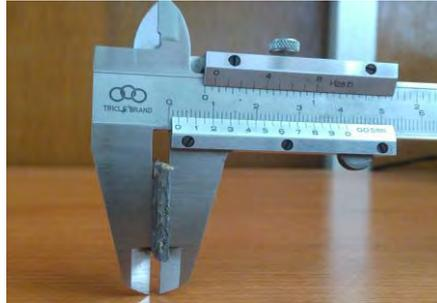
**Gambar 4.14** Pengukuran ketebalan lapisan menggunakan jangka sorong
