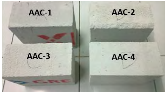
Gambar 3.2 Sampel bata ringan yang telah dipotong
