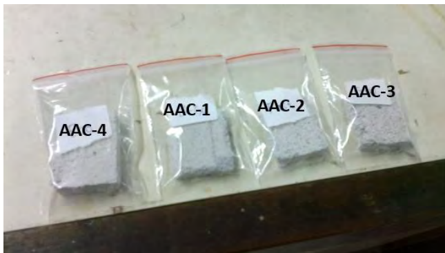
Gambar 3.4 Sampel bata ringan untuk uji EDX
