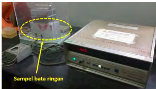
Gambar 3.6 Setup pengujian konduktivitas termal bata ringan
