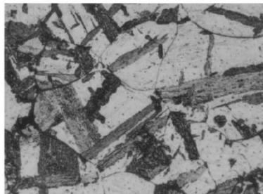
**Gambar 2.14** *Upper bainite* (berwarna gelap) pada baja 4150. Etsa nital, 500x. (Krauss, 2005)
