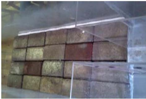
Gambar 4. Model sedimentasi hilir alat ukur
