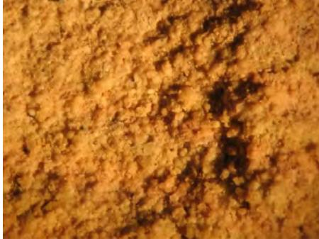
**Gambar 4. 1** Hasil *coring* pada sumur TG-1 merupakan reservoir karbonat *Globigerina* pada kedalaman 941.22 m (Sumber: Dokumentasi instansi)
