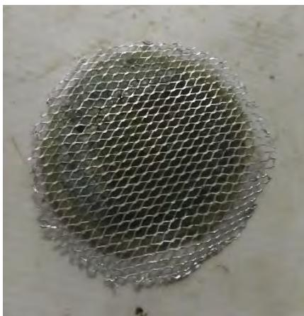
**Gambar 4. 7** Setelah digunakan pada tekanan 1,5 bar
