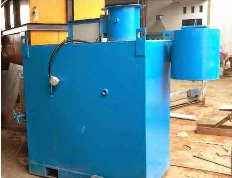
Gambar 5.12 Incinerator 0,3 m<sup>3</sup>/jam
