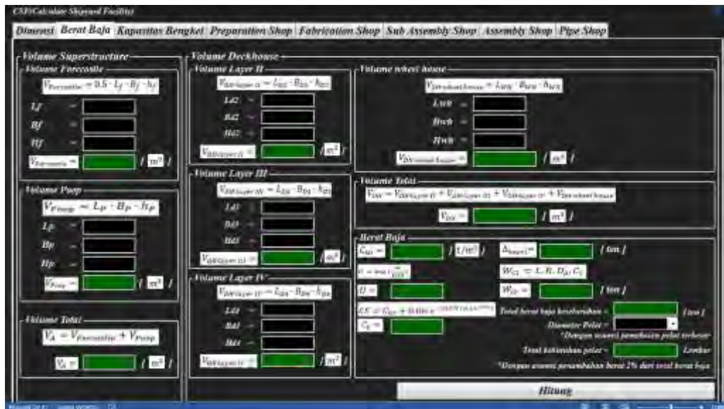
Gambar 5.8 Proses Penghitungan Berat Baja Kapal yang Terpasang dan Kebutuhan Pelat
