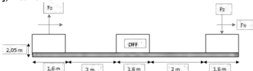
Gambar 4.13 Asumsi 10 Dimana 2 Mesin Bekerja Arah Vertikal Berlawanan dan Mesin Tengah Mati
