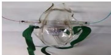
**Gambar 4. 13.** Sensor serat optik berstruktur SMS yang telah dimasukkan kedalam masker
