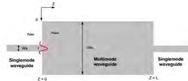
**Gambar 2. 6.** Skema pandu gelombang *multimode* pada serat optik SMS (Hatta, 2009)
