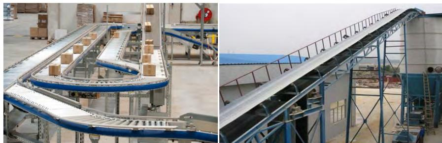
Gambar 2.3 Jenis *Roller Conveyor* dan *Belt Conveyor* Gantung (SSI Schafer dan Baska )
