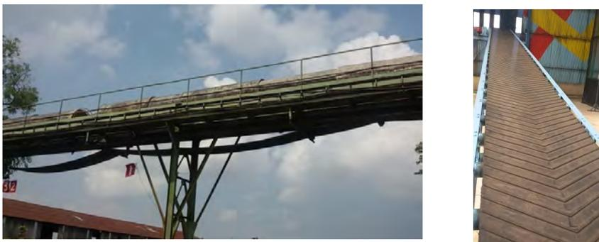
Gambar 4.13 Belt *Conveyor* Gantung di PG Rejo Agung Baru.
