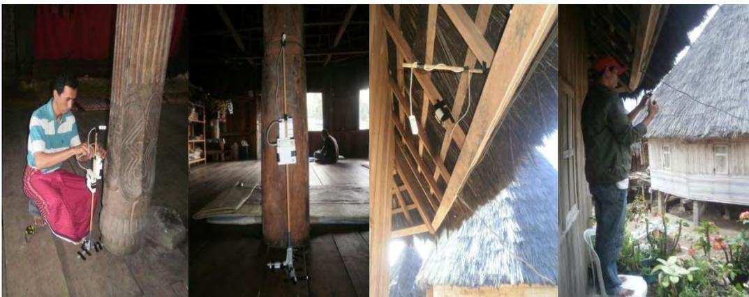
Gambar 3.10 Pemasangan alat ukur *Data Logger* diluar dan didalam bangunan (sumber: dokumentasi pribadi, 2014).
