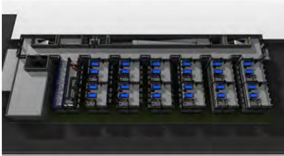
Gambar 5.7. Isometric lantai 2 zona rawat inap.
