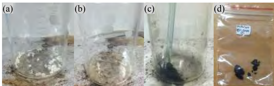
Gambar 3.11 Proses pembuatan komposit BaM/PET ; (a) Pellet PET, (b) Lelehan PET berwarna coklat muda, (c) dan (d) Gumpalan komposit BaM/PET berwarna hitam
