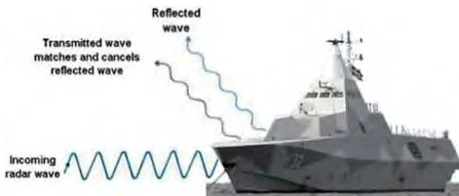
Gambar 2.2 Ilustrasi Penyerapan RAM pada Kapal HMS Helsingborg 32
