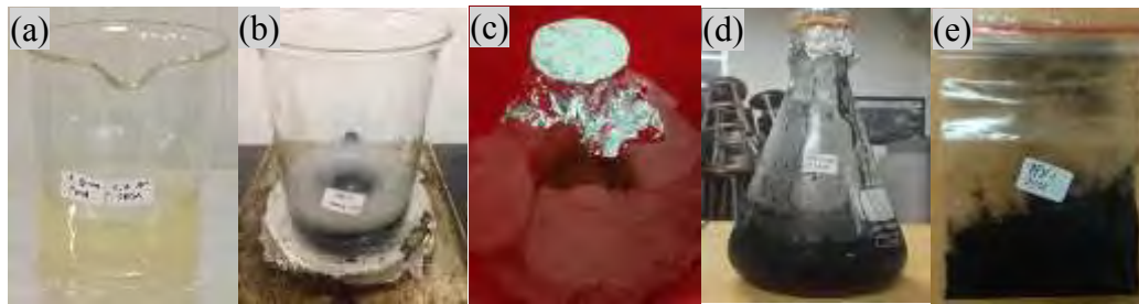
Gambar 3.10 Proses pembuatan komposit BaM/PPy ; (a) Larutan F, (b) Larutan G, (c) Larutan G+APS, (d) Larutan kehitaman, (e) Serbuk komposit BaM/PPy
