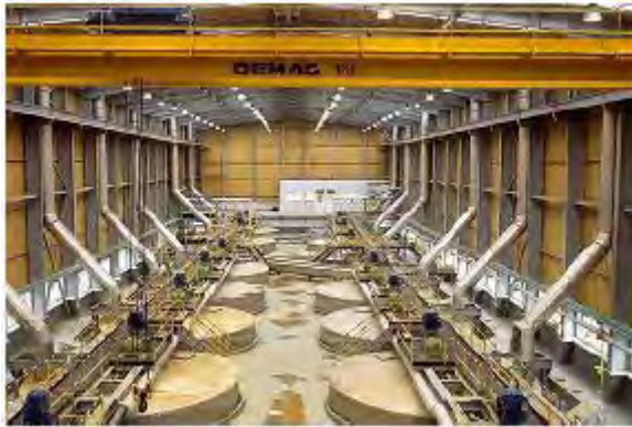
Gambar 2.4 Tangki Proses Leaching yang Terbuat dari Super Duplex grade 2507 (UNS S32750) (Armas dan Moreuil, editor, 2009)
