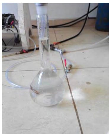
Gambar 3.17 Bubling larutan KOH dengan gas nitrogen
