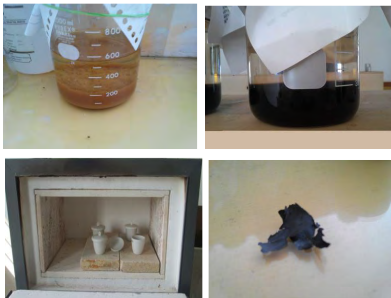
Gambar 3.6 Proses pencucian dan pengeringan hingga terbentuk lembaran grafit oksida.
