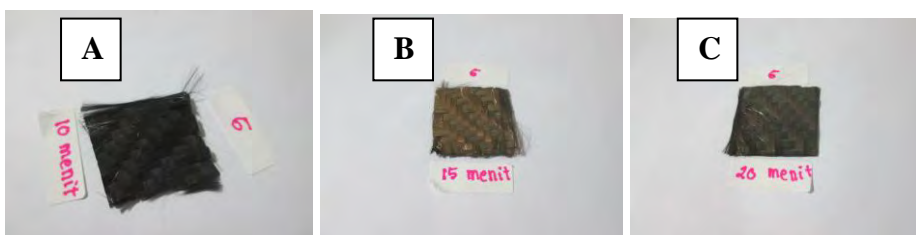
Gambar 3.11 Spesimen carbon cloth/graphene setelah di sputter Au dengan variasi waktu (a)10 (b)15 (c)20 menit, ukuran sampel 2x2 cm.
