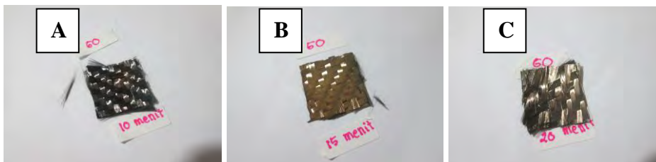
Gambar 3.10 spesimen carbon cloth/graphene oksida setelah di sputter Au dengan variasi sputter time (a)10 (b)15 (c)20 menit, ukuran sampel 2x2 cm
