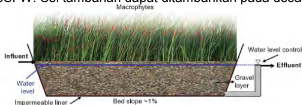
Gambar 2.3 Ilustrasi Aliran Air Pada SSFW (Sumber: Stefanakis et al., 2014)
