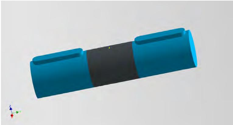
**Gambar 4. 6** Gambar 3 Dimensi Poros dan Split Ring Yang Telah Disambungkan
