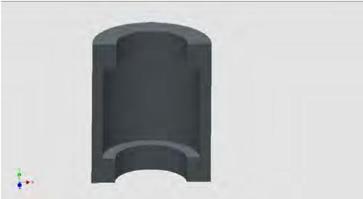
**Gambar 3. 2** Desain Split Ring Screen Wash Pump Saat Ini
