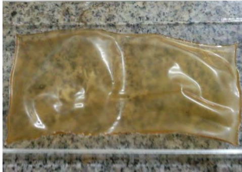
Gambar 4.10 Membran Komposit Kitosan/Monmorillonit Termodifikasi Silan 10 %
