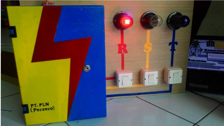
Gambar 4.29 Indikator Lampu Fasa S dan T Mati
