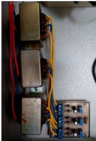
Gambar 3.5 Hasil Pembuatan Sensor Tegangan
