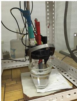
**Gambar 3. 7** Alat Uji Polarisasi PGSTAT128N
