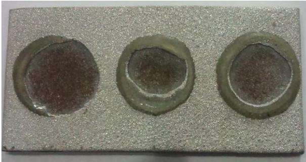
**Gambar 4. 2** Hasil Pengujian Daya Lekat Material *Coating*
