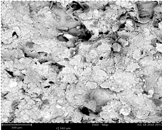
**Gambar 4.11** Pencitraan SEM perbesaran 500x Jarak *Nozzle* 100 mm
