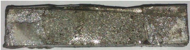
**Gambar 4.3** Spesimen Uji Polarisasi
