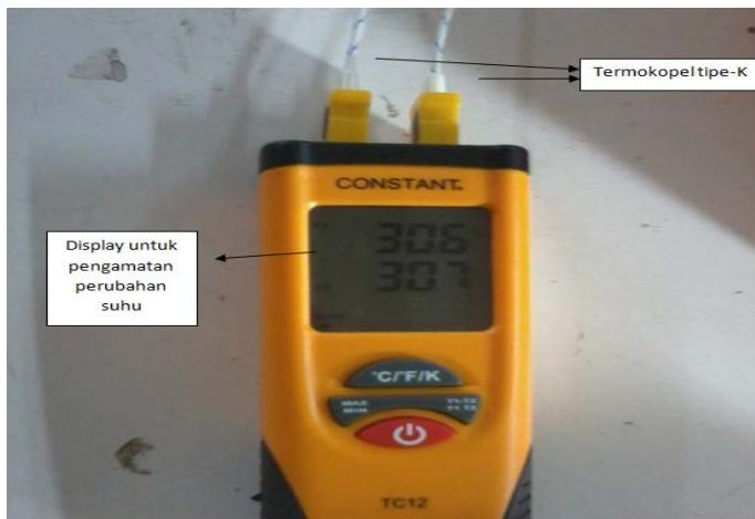
**Gambar 3.7** Termometer digital yang digunakan pada penelitian
