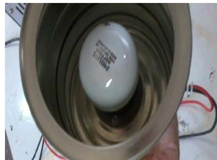
**Gambar 3.10** Kaleng bagian atas untuk meletakkan sumber panas berupa lampu bohlam 100 watt
