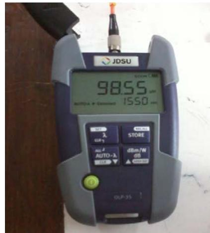
**Gambar 3.9** *Optical power meter* untuk mengamati nilai rugi daya
