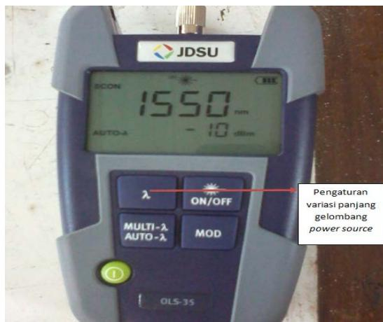
**Gambar 3.8** Optical power source yang digunakan pada penelitian
