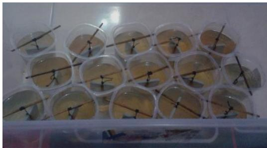
**Gambar 3.15** Proses *Immersion Unscratch* selama 14 hari
