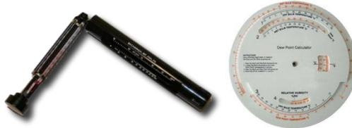
**Gambar 3.5** Alat *Sling Psychrometer* dan *Dew Calculator*
