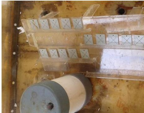
**Gambar 3.16** Proses Pengujian Sembur Garam
