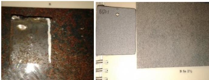
**Gambar 3.9** Spesimen yang Digunakan Sebelum dan Sesudah Dilakukan Blasting dan Dibandingkan dengan Standar
