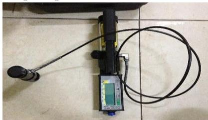
**Gambar 3.12** Peralatan Uji Kekuatan Adhesi
