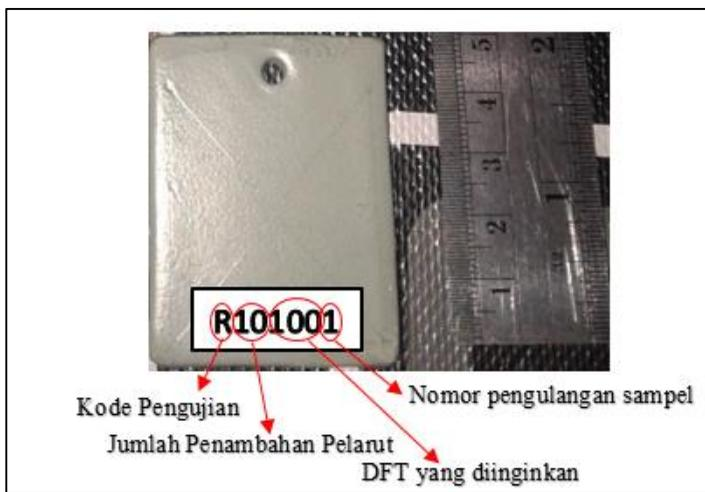
**Gambar 3.14** Contoh Sampel Pengujian Sembur Garam dan Penamaan Sampel
