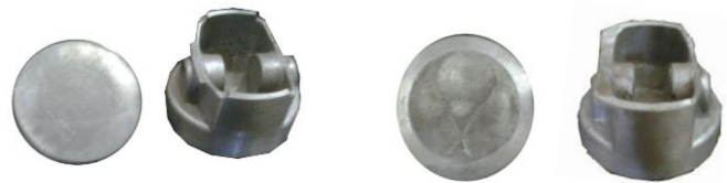
Gambar 1 Piston yang dihasilkan dari cetakan (a)matras datar (b) matras berpola
