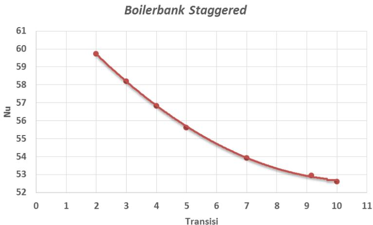
**Gambar 4.8** Nusselt Number rata-rata *Boilerbank Tube* tipe *Staggered* pada variasi jarak transisi  $2D$ ,  $3D$ ,  $4D$ ,  $5D$ ,  $7D$ , *existing*, dan  $10D$ .
