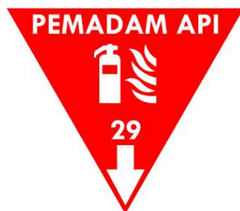
Gambar 6.7 Tanda Pemasangan APAR (Sumber: keselamatandankesehatan kerja.com)
