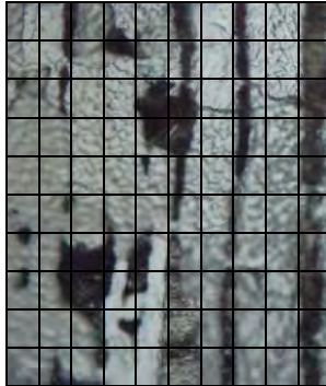
Gambar 4.12 Struktur mikro daerah Base Metal temperatur 900°C pada sumbu x14
