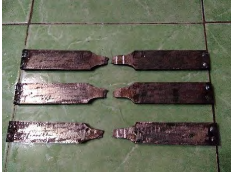
Gambar 4.2 Pengujian Tarik Pada Spesimen Setelah Pengaruh Panas Temperatur 700°C
