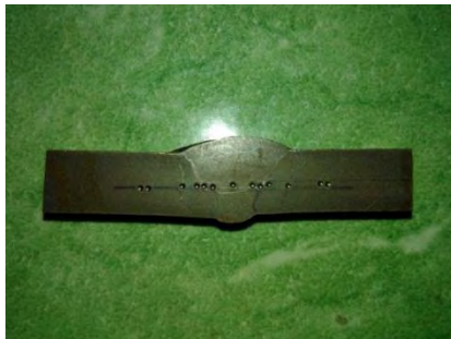
Gambar 4.6 Letak Indentasi pada Uji Kekerasan Temperatur 700°C
