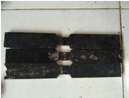
Gambar 3.10 Spesimen Uji Tarik Suhu 900 0 C
