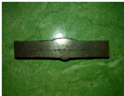
Gambar 4.7 Letak indentasi pada uji kekerasan temperatur 900°C
