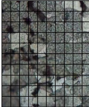
Gambar 4.13 Struktur mikro daerah Weld Metal temperatur 900°C
