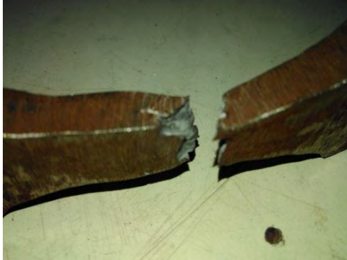
Gambar 4.4 Daerah Putus Pada Spesimen SA 36 Setelah Terkena Pengaruh Panas Temperatur 700^{\circ}\text{C} Terletak Pada Base Metal
