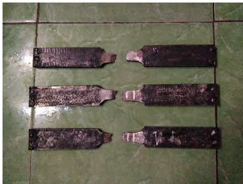
Gambar 4.3 Pengujian Tarik Pada Spesimen Setelah Pengaruh Panas Temperatur 900°C
