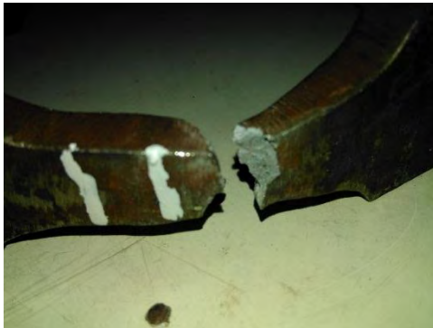
Gambar 4.5 Daerah Putus Pada Spesimen SA 36 Setelah Terkena Pengaruh Panas Temperatur 900^{\circ}\text{C} Terletak Pada Base Metal
