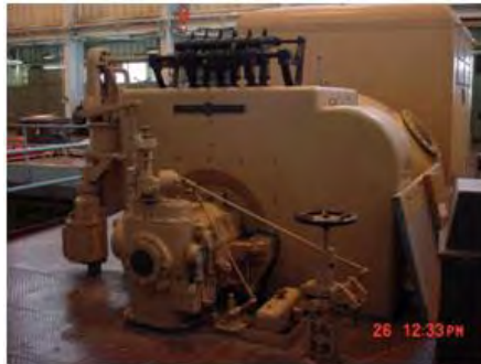
gambar 2.1 Control valve pada steam turbin (sumber :[6])
