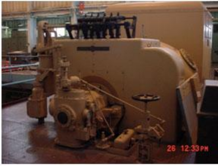
gambar 2.1 Control valve pada steam turbin (sumber :[5])
