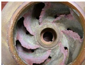
Gambar 2.10 Korosi erosi sebuah blade
