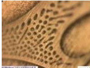
Gambar 2.1 Foto SEM paduan Mg 6 Zn dengan penambahan 3 wt.% Ca dengan perbesaran 1000 kali
