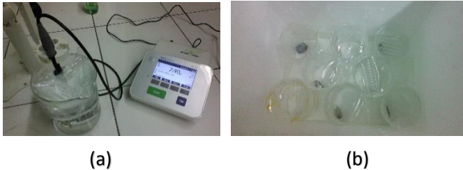
Gambar 3.2 Pengukuran pH dan penyimpanan sampel (a) pengukuran pH larutan dengan pH meter (b) penyimpanan sampel untuk menjaga suhu tetap konstan.
