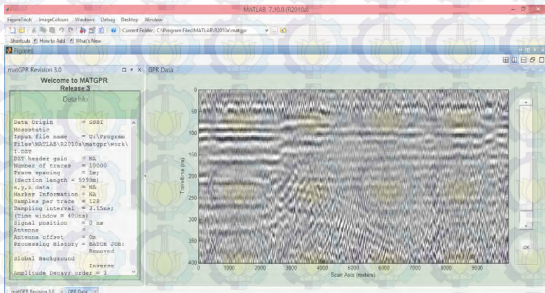
Gambar 4.6. Penampang GPR setelah dikenakan Bandpass Filter
