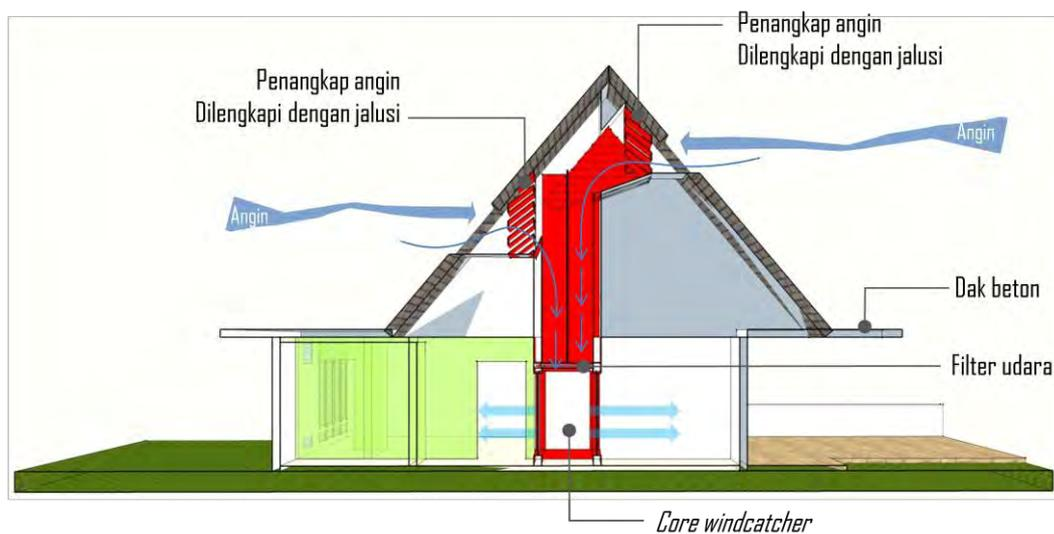
Gambar 4.48 *Core windcatcher* pada rumah ketiga
