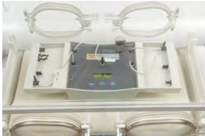
*Gambar 3.1 Peletakan INCU Analyzer*
