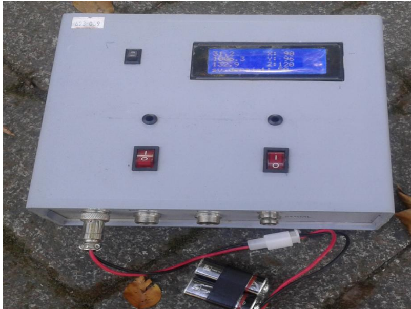
Gambar 4.2 Sensor Ketinggian Berbasis Tekanan Yang siap Di Kalibrasi
