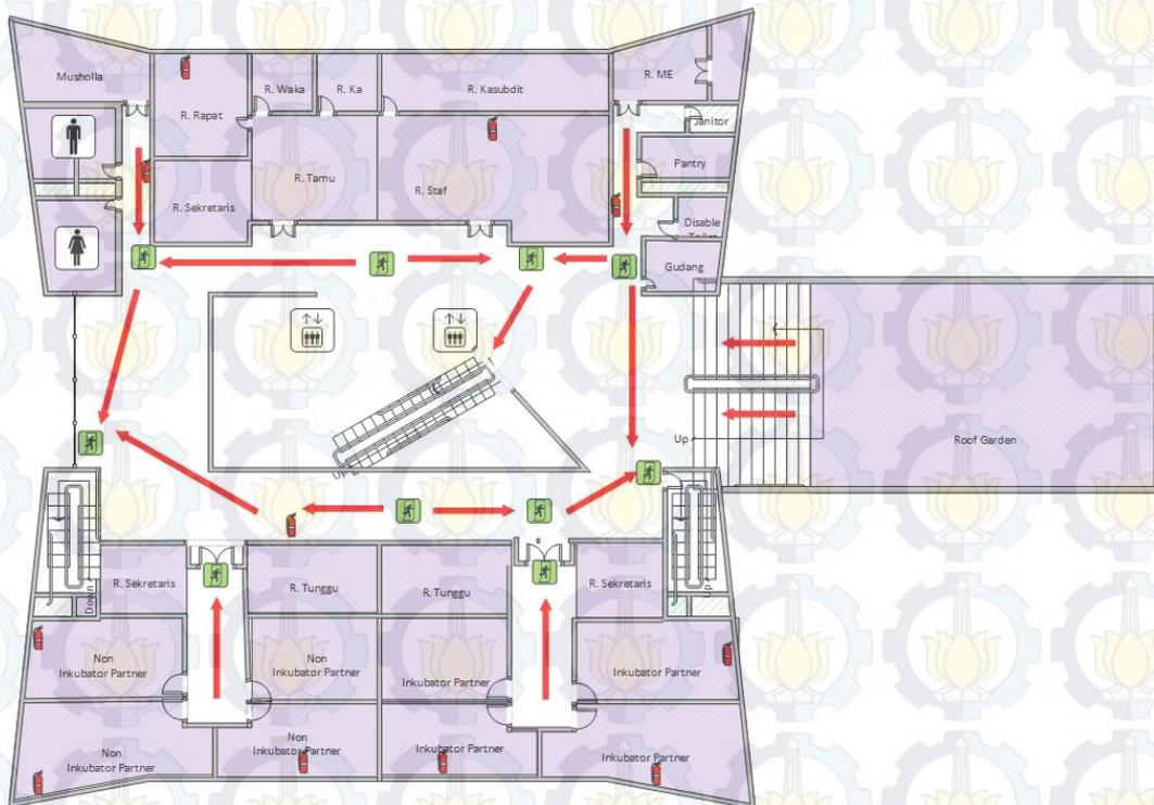
Gambar 5.2 ERP dan Lokasi APAR pada lantai tiga sebelum *adjustment*
