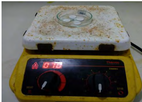
Gambar B.5. Pemanasan sampel padatan komposit PEG 4000-Silika kristobalit setelah proses tekan.
