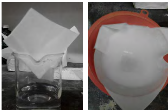
Gambar B.2. Proses penyaringan dengan kertas saring sampel gel silika yang didapat setelah proses pencucian dengan akuades.
