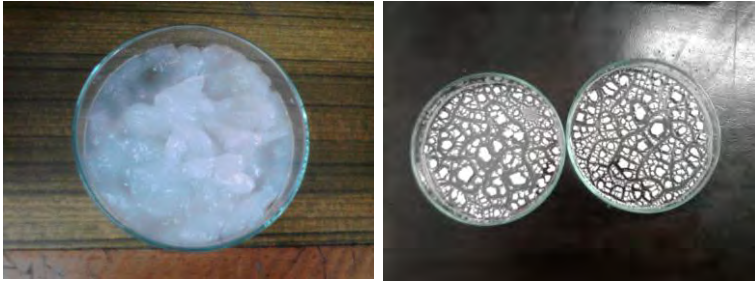
Gambar B.3. Gel silika sebelum dan setelah pemanasan pada temperatur 100 °C untuk menghilangkan kadar air dalam gel.
