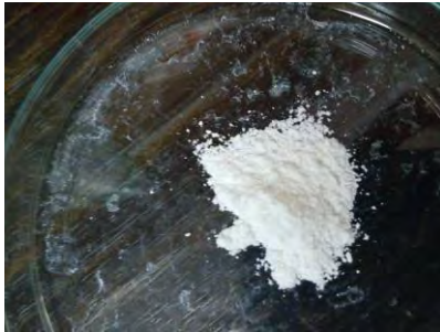
Gambar B.4. Serbuk silika setelah kalsinasi pada temperatur 950 °C selama 8 jam (SC)
