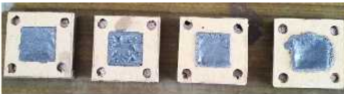
Gambar 4.19 Pelapisan Single Layer pada Plat Baja AH36
