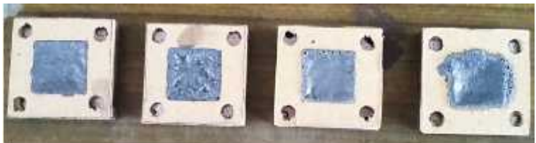
Gambar 9. Pelapisan Single Layer RAM pada Plat Baja
