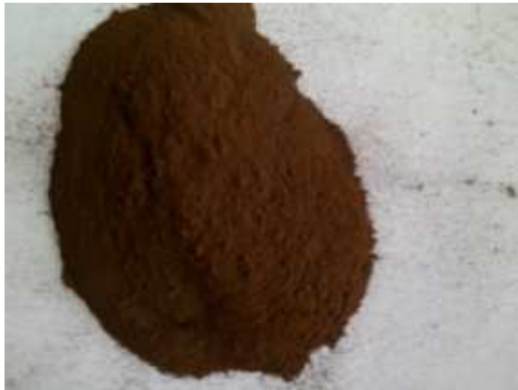
Gambar 2.2 Pasir Besi Tanah Laut yang Telah dihancurkan Sebelum Pencucian
