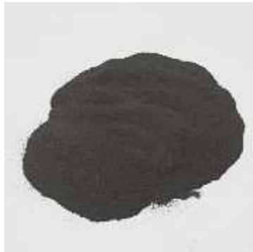
Gambar 4.1 Pasir Besi Laterit Sebelum Pencucian
