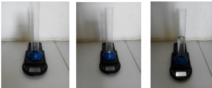
Gambar 3.26 Pengujian Densitas (a) gelas ukur, (b) gelas ukur+spesimen, (c) gelas ukur+air+spesimen
