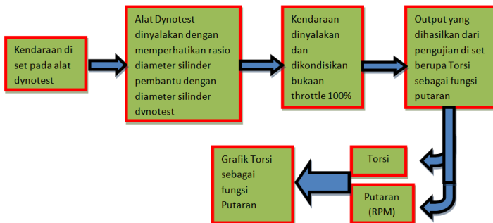
Gambar 3.5 Skema Pengujian Torsi sebagai Fungsi Putaran
