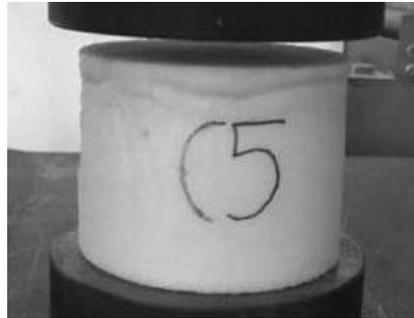
**Gambar 4.19** Perilaku Rigid PU *foam* ketika dikenai beban tekan, dihentikan sebelum *hardening*
