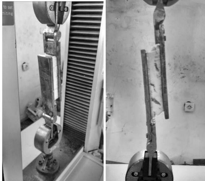
**Gambar 4.27** Spesimen pengujian geser dan peralatannya
