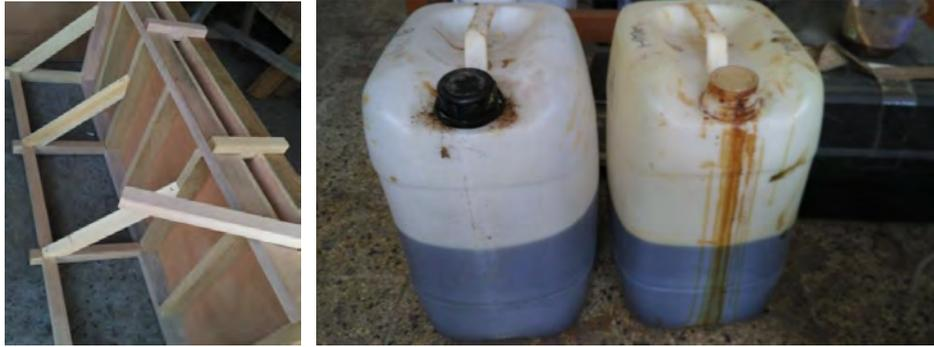
**Gambar 4.36** Perlengkapan pabrikan panel (a) bekisting (b) RPUF cair A dan B
