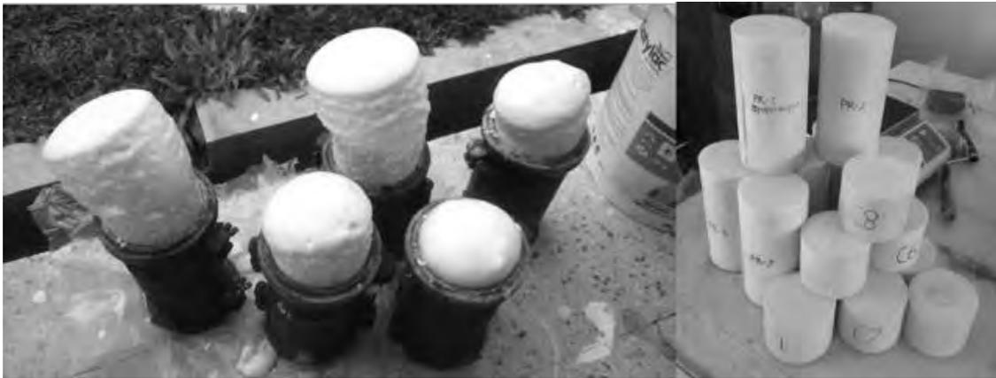
**Gambar 4.16** Pabrikasi specimen Rigid PU foam untuk pengujian kerapatan dan pengujian tekan
