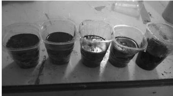
Gambar 4.1 Spesimen pengujian *gel time* dan *peak* eksotermik resin *vinylester*
