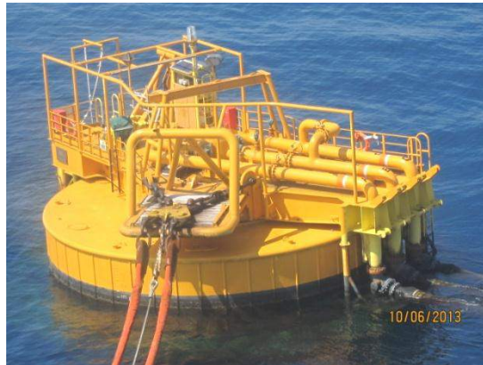
Gambar 2.1 Buoy pada SPM FSO Arco Ardjuna (Sumber: PT. Citra Mas, 2013)
