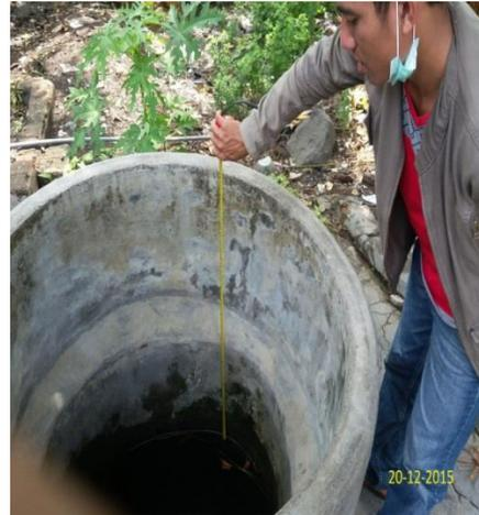
Gambar 5. Proses Pengukuran Kedalaman Sumur
