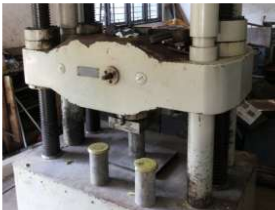
Gambar 4. 3 Pengetesan Benda Uji Silinder
