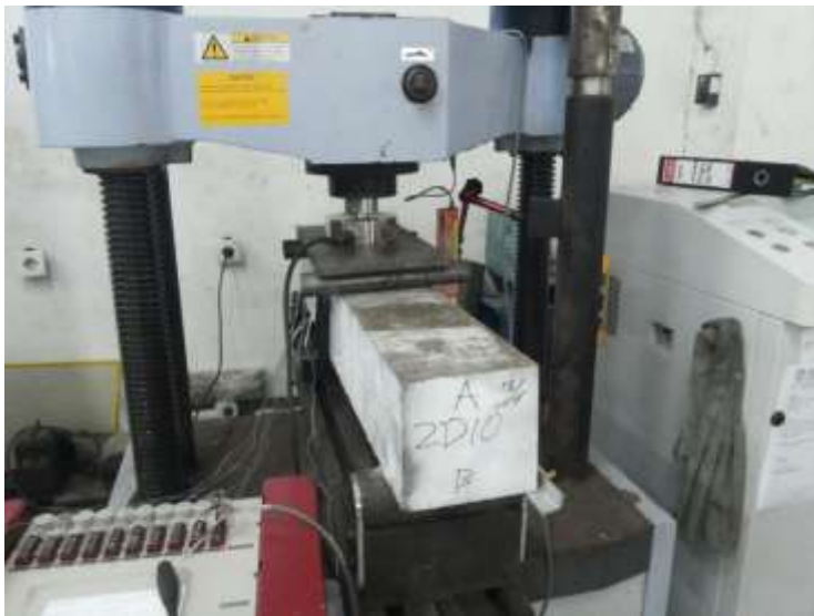
Gambar 4. 4 Pengujian Lentur pada balok
