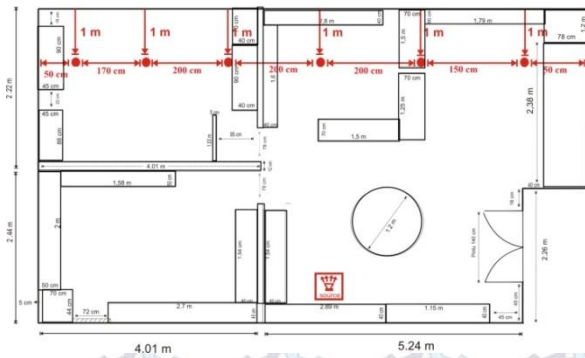
Gambar 1 Denah Ruang Laboratorium Komputer
