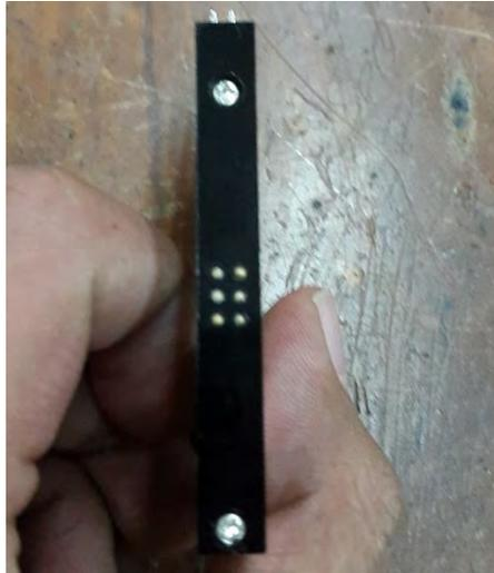
**Gambar 1.6** Modul *Solenoid* dengan matrix 3x2
