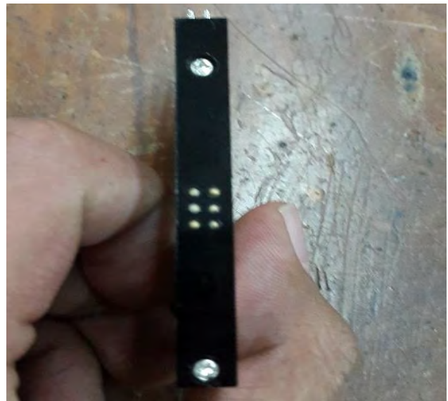
Gambar 2. Modul Solenoid dengan matrix 3x2
