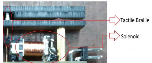
Gambar 6. Tactile Braille dan Solenoid
