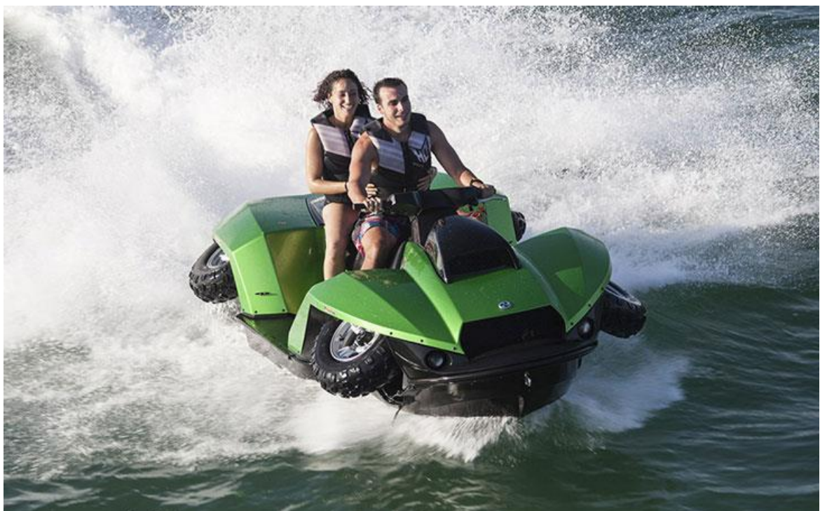
Gambar II.9 Amphibious Quad Jet Ski dengan Roda yang Ditarik ( retracted wheels ) Sumber: (Awesome Stuff 365, 2019)
