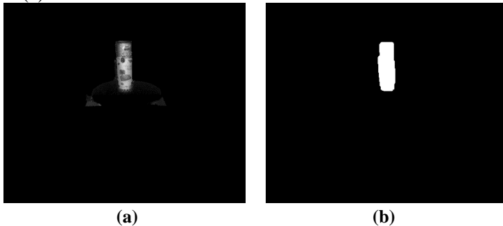
Gambar 3.18 Visualisasi matriks probabilitas obyek (a) dan matriks hasil thresholding (b)
