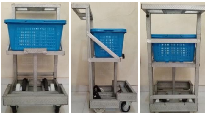
Gambar 3.2 Perancangan mekanik troli belanja
