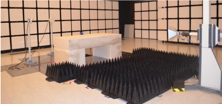
Gambar 3.8 Konfigurasi pengukuran dengan antenna 0,8 – 18 GHz
