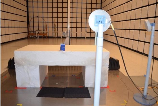
Gambar 1. Penataan segala instrumentasi dalam chamber
